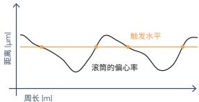
距离传感器定位在距离变化的中间, 并触发测量和图像采集。这确保了光学元件 焦点始终处于正确距离。由于集成了电动式 横动装置,传感器能自动根据不同带材 厚度进行调整。
