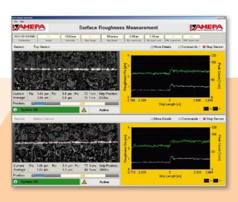
激光线和镀锌的表面纹理(这里是 EDT)清晰可见。示例 截图显示了卷材长度上的在线 Ra 和 RPc 结果与最新的显 微图像。系统的高动态让操作员能在带材更换过程中迅速 纠正粗糙度过冲(在图表的中间)。
