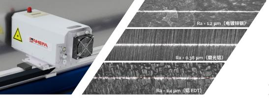
对钢和铝的不同带材表面进行显微图像拍摄,以便于进行质量记录。
